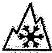
Рисунок 5.1. Маркировка, наносимая на зимнюю шину
